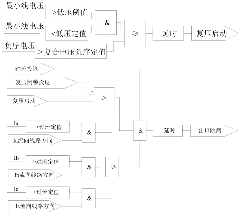
图 8.2 三段式过流保护逻辑
