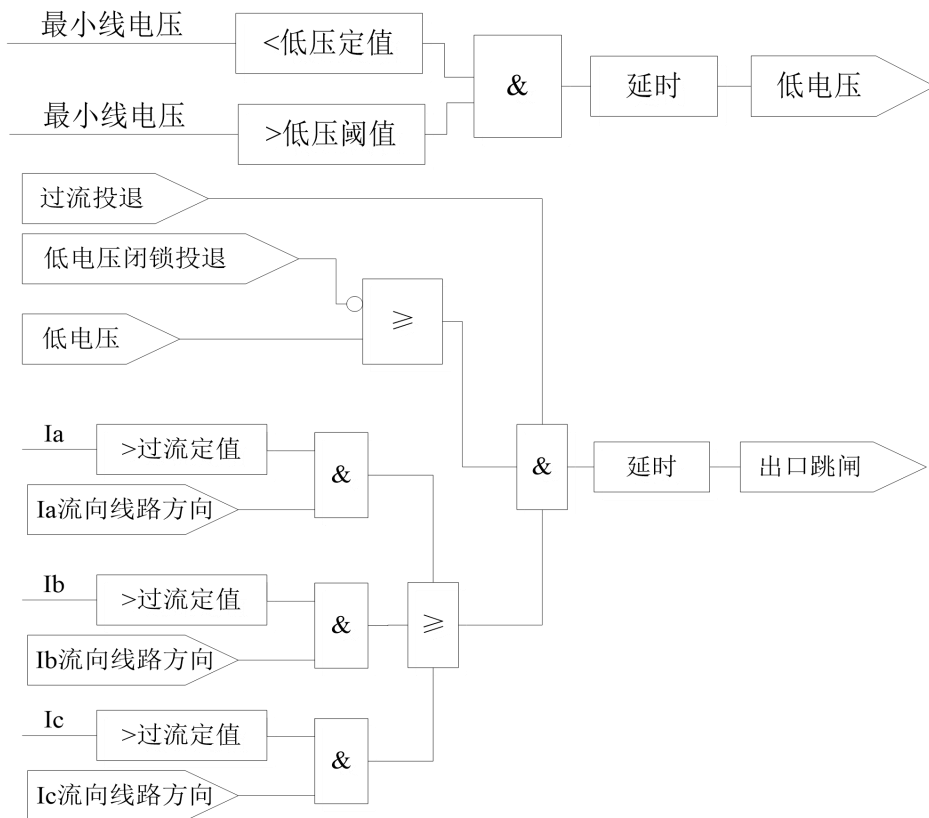
图 1.2 三段式过流保护逻辑
