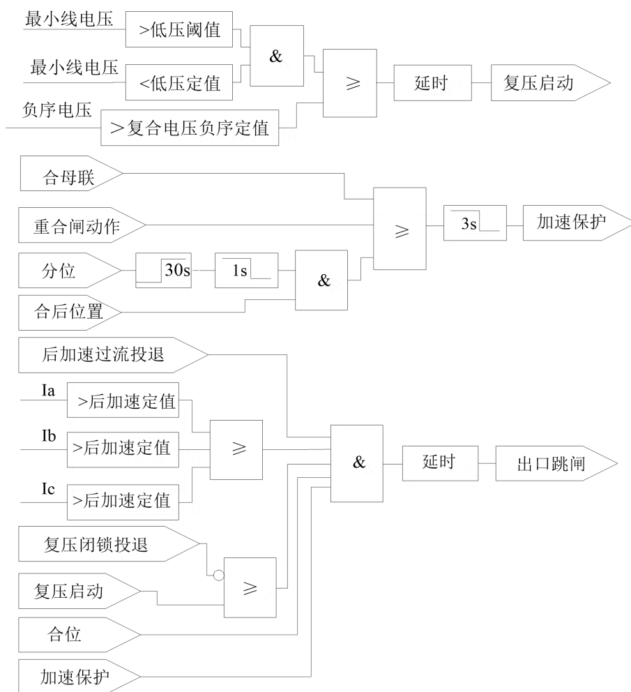
图 4.4 后加速过流保护逻辑
