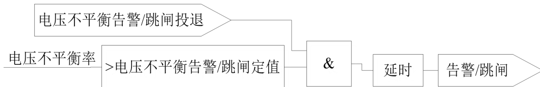
图 6.24 电压不平衡保护逻辑
